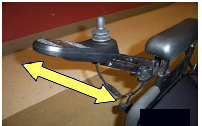
Si le boîtier de contrôle vous gêne lors de vos transferts, il est également possible de l'escamoter. Pour ce faire, il suffit de pousser le boîtier vers l'extérieur.
