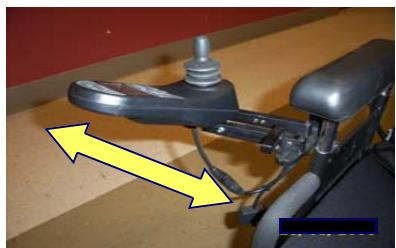
Si le boîtier de contrôle vous gêne lors de vos transferts, il est également possible de l'escamoter. Pour ce faire, il suffit de presser vers le bas le petit levier noir situé derrière le boîtier de contrôle et de pousser le boîtier vers l'extérieur. Pour ramener le boîtier de contrôle, il suffira de le pousser vers l'intérieur jusqu'à ce qu'un "clic" se fasse entendre.
